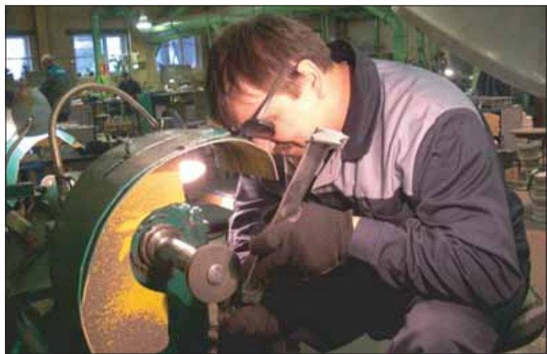
Слесарь механообрабатывающего цеха ПК ЗТЛ Сергей Кириллов выполняет слесарную обработку банджа рабочей лопатки четвертой ступени турбины К-130 для Верхнетагильской ГРЭС.
